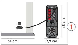
Collegare la stufa a Pellet all'UPS utilizzando il cavo IEC in dotazione.
