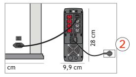
Collegare l'UPS alla presa a muro utilizzando il cavo d'alimentazione della stufa a pellet ed accenderlo, premendo ON.
